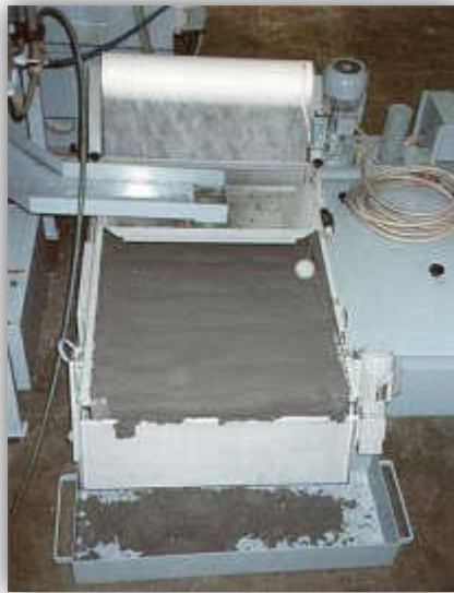
Boues pâteuses en sortie de filtre à bande
