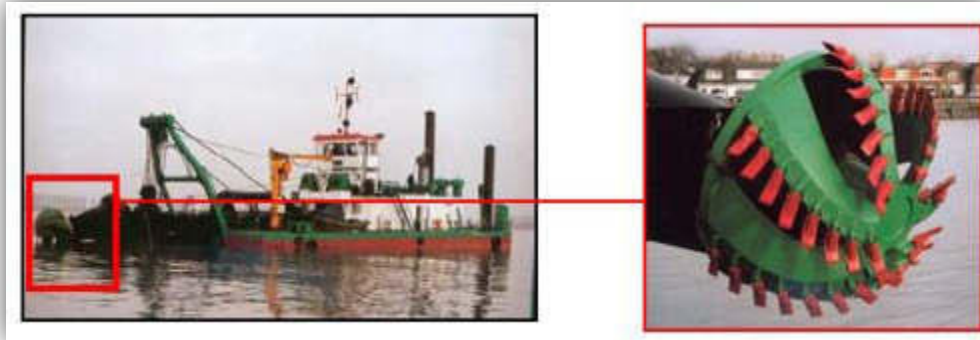
Drague aspiratrice à désagrégateur rotatif et son cutter
