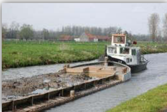
Barge de transport de sédiments poussée par un bateau
