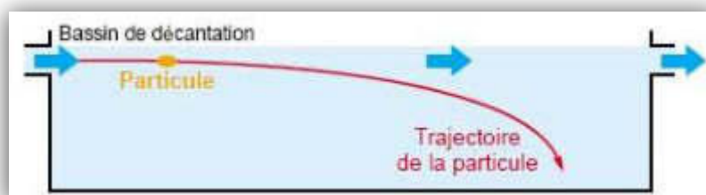
Fonctionnement d'un bassin de décantation gravitaire
