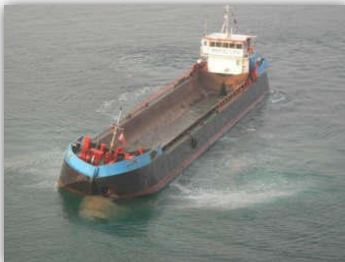
Clapage en mer : ouverture longitudinale du chaland pour laisser tomber sa cargaison
