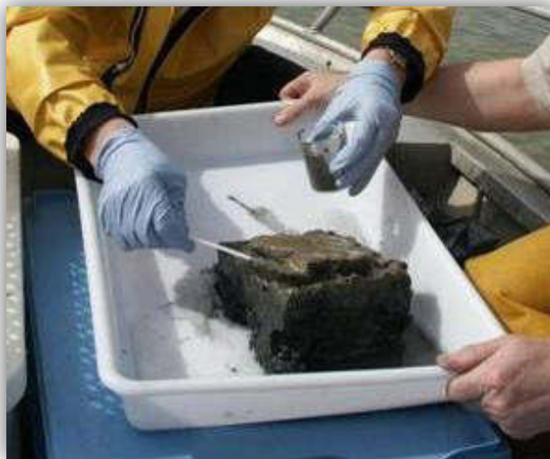
Prélèvement du premier centimètre superficiel d'une carotte obtenue à l'aide d'une benne de type Eckmann sur embarcation légère
